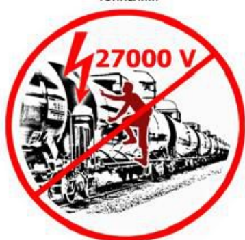
НЕ ПОДНИМАЙСЯ НА ВАГОНЫ И ЦИСТЕРНЫ СТОЯЩИХ ПОЕЗДОВ, ТАМ НАХОДИТСЯ ОПАСНАЯ ЗОНА ВЫСОКОГО НАПРЯЖЕНИЯ ОКОЛО 27000 V
